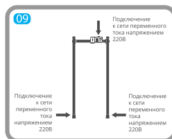
06 Подключите кабели от электронного блока к обеим панелям и подключите шнур электропитания к одной из панелей.
